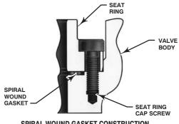
SPIRAL WOUND GASKET CONSTRUCTION (STANDARD CONSTRUCTION)
