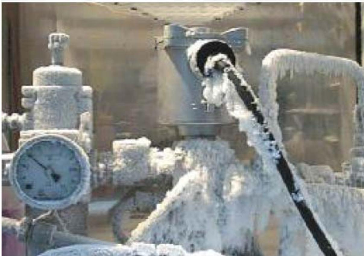
Bifold电磁阀通过：独特的增磁电枢板架与动铁芯配合，顶针驱动，驱动部分与阀体部分的完全隔离，嵌入式面密封及耐低温密封材料选择等设计，使Bifold电磁阀具有优异的耐低温特性，工作范围更广。在-60°C的超低温环境下依然能保证稳定可靠的工作。Bifold电磁阀在全球范围内广泛的应用与北极，南极，俄罗斯等极端寒冷的环境。
