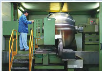
车/磨一体化数控球机正在加工48"球体
