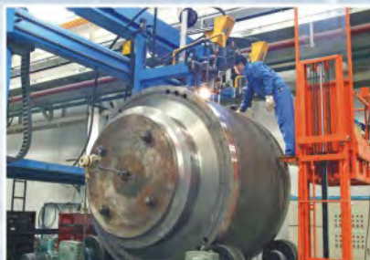
48" 900级全焊接球阀正在焊接主焊缝
