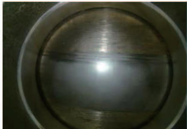
金属粘接及蠕变对硬密封系统的破坏
