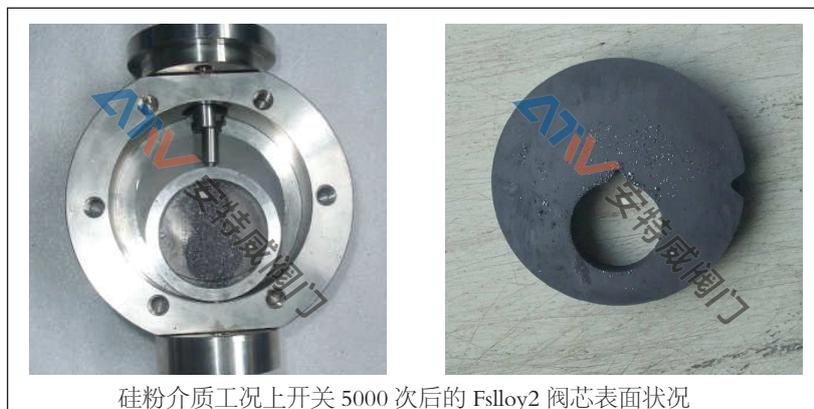
FSLLOY 材料制成的阀芯能适用于包括硅粉等各种极其恶劣的工况。
