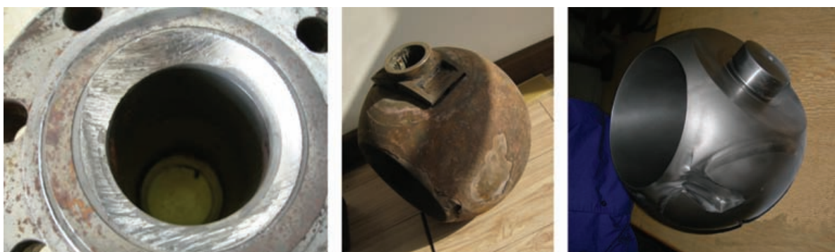
附着、腐蚀和冲刷对硬密封系统的损坏
