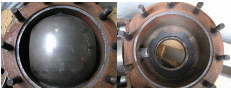
硅粉介质开关 12,000 次后的 Cr13+FSLLOY14 涂层的阀球和阀座
