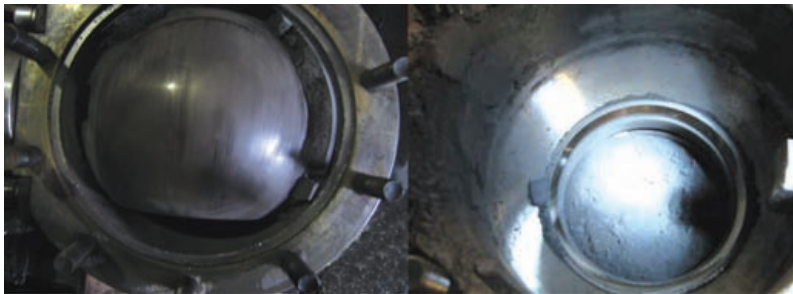
干煤粉介质开关 100,000 次后的 F51+FSLLOY12 涂层的阀球和阀座
