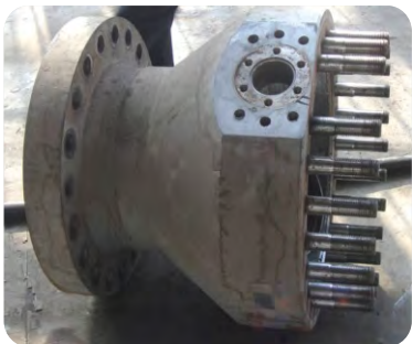
齐鲁二化锁渣阀维修
